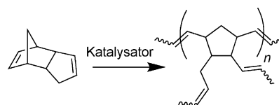
Schema 4. ROMP von DCPD zur Bildung von hochgradig vernetztem pDCPD.
